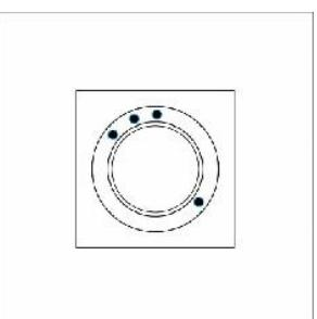
При нажатии на поворотную ручку в режиме «вентиляция с рекуперацией» включаются синие светодиоды, и устройства начинают работать в режиме «вентиляция», т.е. реверс выключен, и в помещения начинает поступать холодный воздух наружной температуры.
