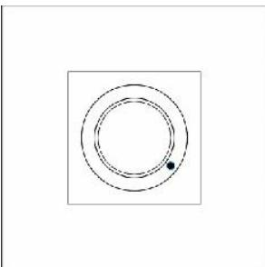
Индикация одним зеленым светодиодом при повороте ручки регулятора по часовой стрелке обозначает первую скорость, двумя – вторую и т.д. В данном режиме вентиляционная система наиболее эффективно накапливает тепло удаляемого воздуха в тепловом аккумуляторе и отдает его входящему извне свежему воздуху.
