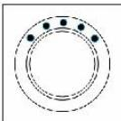
Верхний ряд светодиодов зелёного цвета показывает скорость, на которой работают вентиляционные устройства. Один светодиод обозначает самую низкую скорость вентиляторов, а пять – самую высокую. Таким образом, Ваши вентиляционные устройства могут работать на 5 разных скоростях. Повернув ручку регулятора по часовой стрелке, Вы можете увеличить скорость вентилятора, против часовой стрелки – снизить ее.
