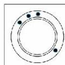
Одновременная индикация светодиодами, которые обозначают **скорость (зеленый)** и **вентиляцию (синий)**, показывает, что вентиляционные устройства работают в режиме «вентиляция» на определенной скорости.
