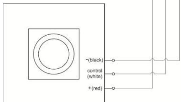
Трансформатор в стандартной комплектации имеет мощность 25 Вт и рассчитан на подключение до 4-х вентиляционных устройств. Для подключения большего количества устройств необходимо обеспечить более высокую мощность сети (5 Вт на одно устройство).
