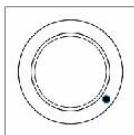
Синий светодиод внизу справа показывает, что устройство включено в режиме «вентиляция». Это значит, что устройства, подключенные к данному регулятору, работают без возврата тепла (рекуперации), т.е. вентиляторы работают без смены направления/реверса, а воздух, который подается в помещения, имеет наружную температуру.
