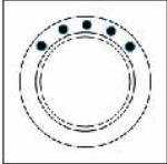
При повторном нажатии на ручку начинает мигать синий светодиод, что означает: вентиляционные устройства работают в режиме «вентиляция», но сменили направление потока воздуха. Так, например, если в помещении 1 вентиляционное устройство работало на подачу воздуха, а в помещении 2 – на вытяжку, тогда теперь воздух будет выводиться из помещения 1, а подаваться в помещение 2.
