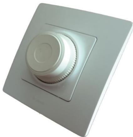
Регулятор Twist призначений для управління рекуператорами Ventoxx серії RV-3. Регулятор Twist має максимально просте, інтуїтивно зрозуміле управління вентиляцією. При цьому виконання всіх функцій здійснюється однією поворотною ручкою. Рекуператори Ventoxx оснащені «smart» вентиляторами, в які вбудована силова частина і управління. Таким чином, регулятору залишається тільки подати потрібний сигнал на вентилятор.
